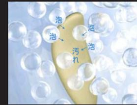
最初に…直径約5mmのミリバブルが汚れを強力に剝がします。
